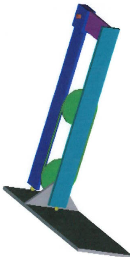
Figura 5 - Mecanismo com uma biela-manivela e engrenagem de corrente
